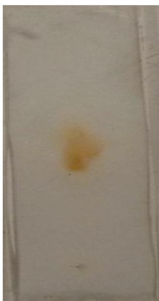
**Placa de silicagel GF254****Muestra:** Fase etanolica (I.3.2)**Solvente de recorrido:** Cloroformo: ácido acético:
