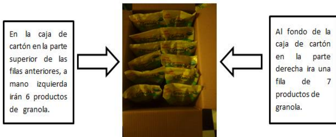
FIGURA No. 26 POSICIÓN DE LAS GRANOLAS EN LA CAJA DE CARTÓN NUTRICEREAL II
