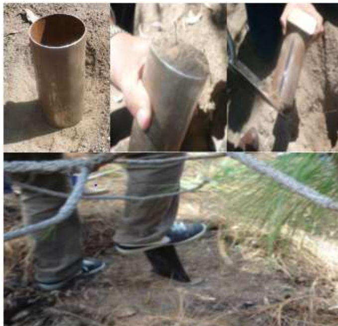
Fotografía 1-2: Metodología para la determinación de la densidad aparente en el suelo
