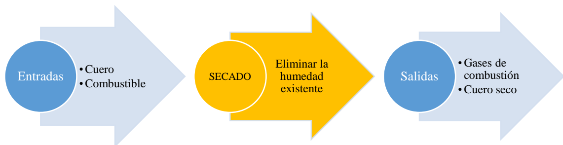
Figura 23-3: Secado Fuente: Curtiduría Serrano
