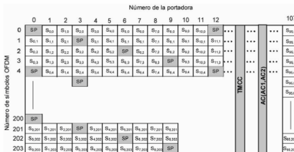
Figura 33 — Configuración del segmento OFDM para modulación síncrona (QPSK, 16QAM, 64QAM) en el modo 1
