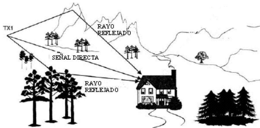
Figura IV.4 Diagrama del efecto del multitrayecto.
