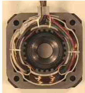
Figura II.11.- Imagen de un estator de 4 bobinas.
