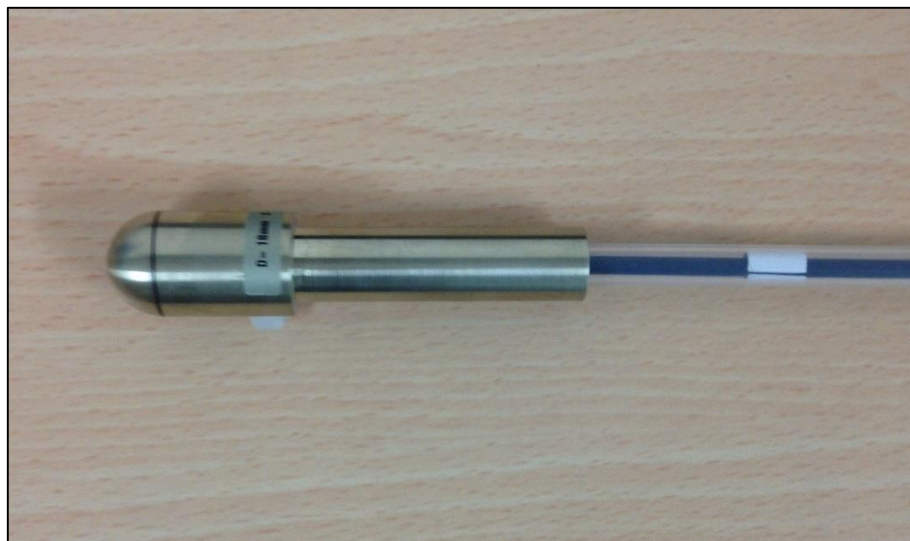
FIG. 2.7 Buildup montado en una cámara cilíndrica para medir el CSF. Fuente: Tesista
