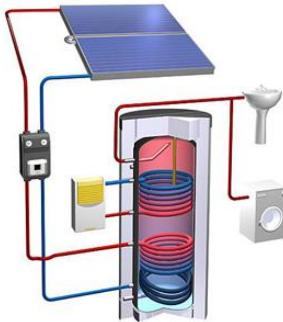
Figura 7. Sistema auxiliar en el acumulador solar
