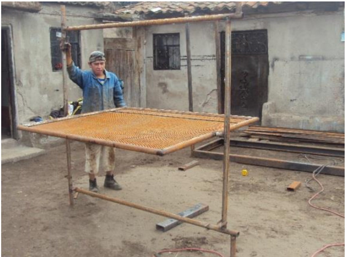
Gráfico 13. Sujeción de la malla con el marco de soporte mediante el eje de giro.
