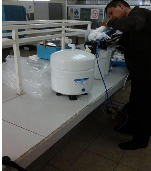
FOTOGRAFÍA 9: Preparación del equipo de ósmosis inversa – desionizador
