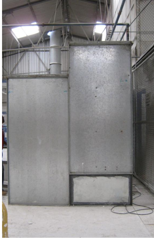
Figura 53: Vista lateral de cabina de esmaltado con cortina de agua armada provisionalmente.
