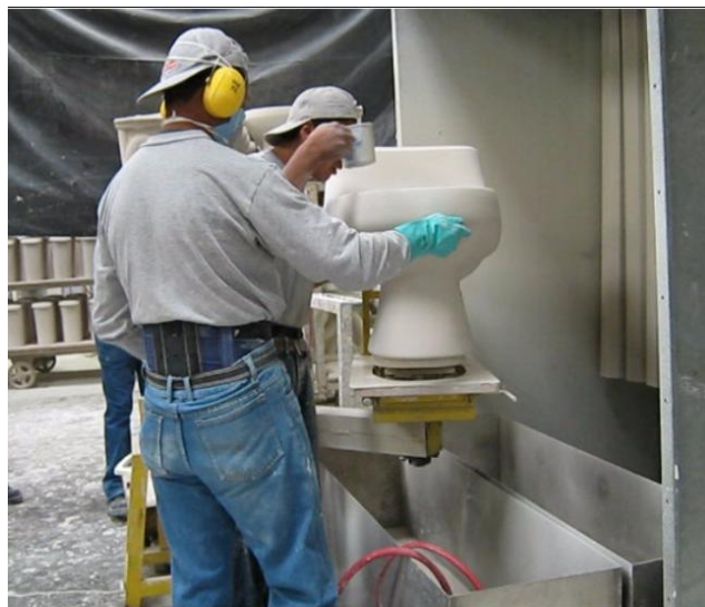
Figura 59: Colocación de esmalte en la pieza previo al sifoneo.
