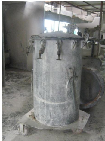
Figura 25: Tina de presión de esmalte cerámico.
