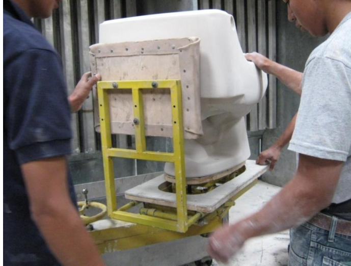
Figura 58: Colocación de espaldar en la pieza cerámica sobre el brazo de esmaltado.
