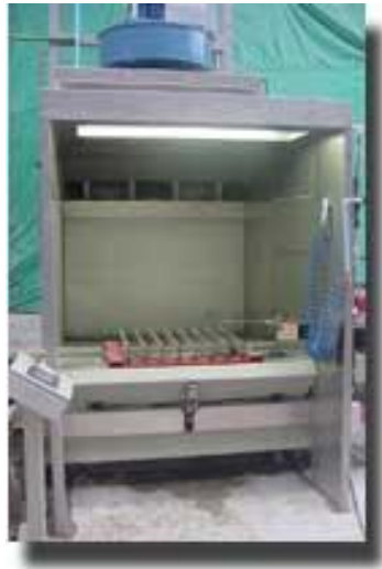
Figura 14: Sistema de remoción de partículas por lavado de aire por succión.
