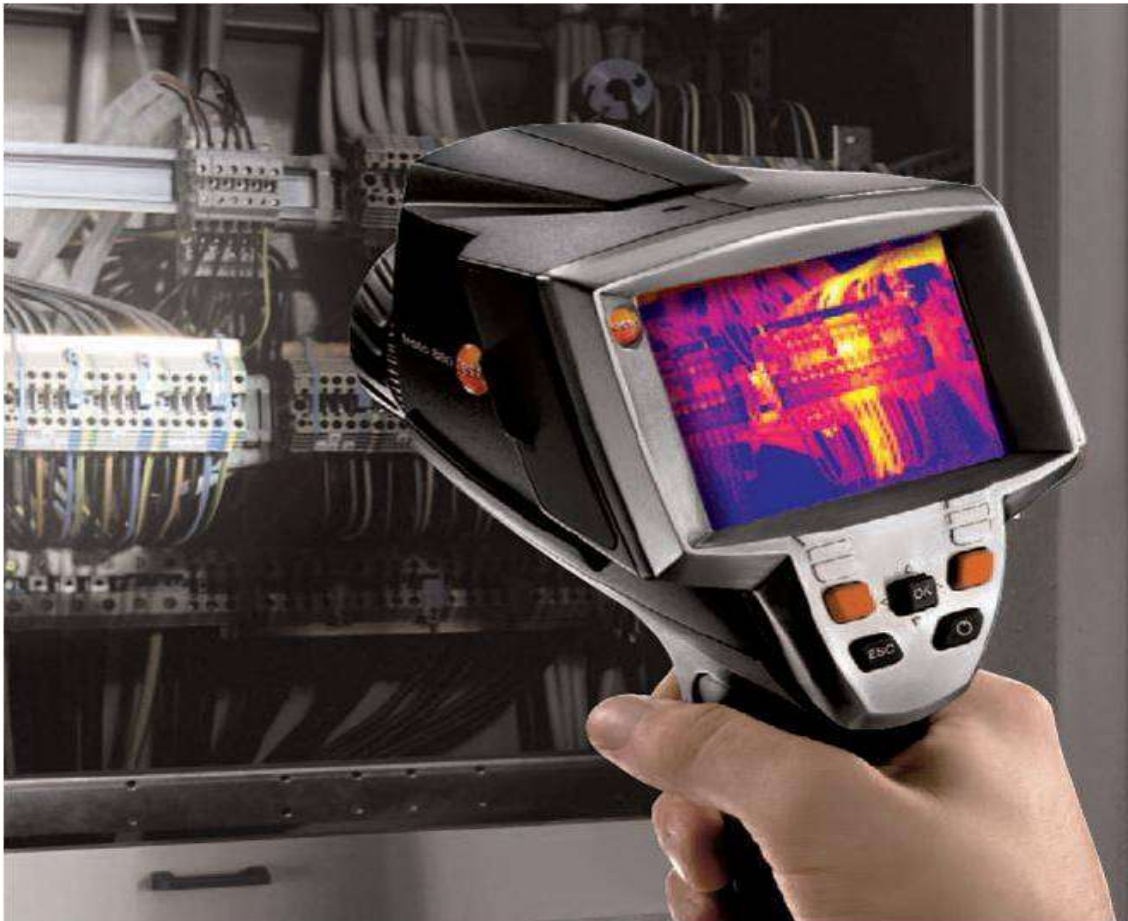
Figura 2.9 Medición de temperatura con cámara infrarroja a distancia
