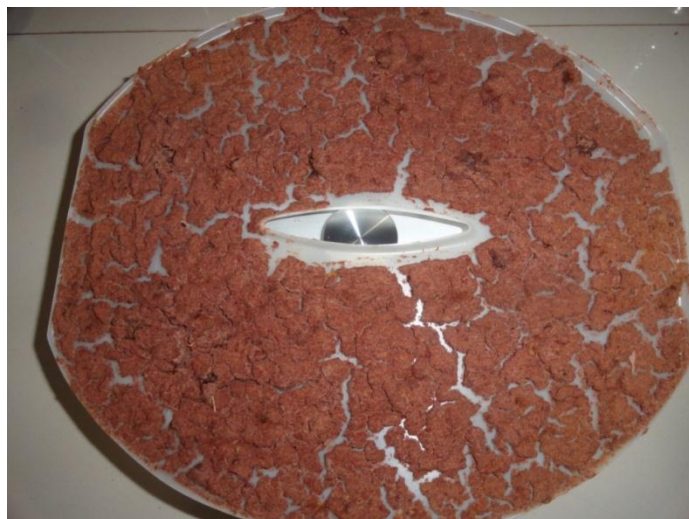
FOTOGRAFÍA N°5: DESHIDRATADO DE LA MEZCLA HOMOGÉNEA
