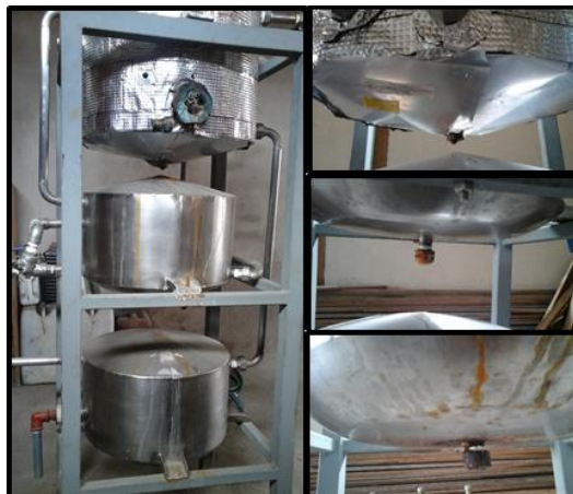
Figura 39-2: Humedad presente en el equipo
