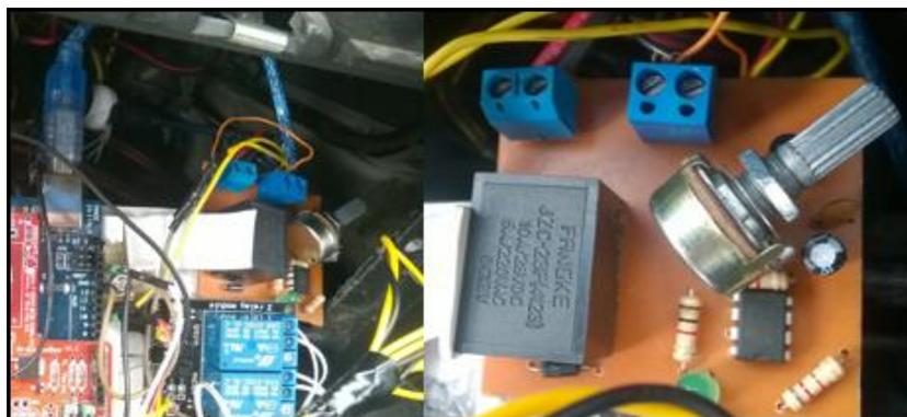
**Figura 50-2:** Instalación del actuador limitador de velocidad.
