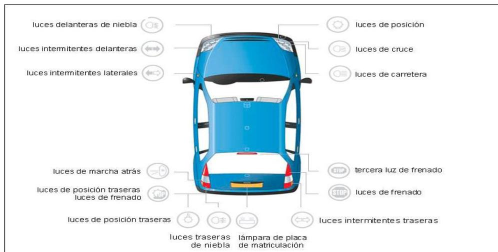
**Figura 5-1:** Sistema de iluminación del automóvil
