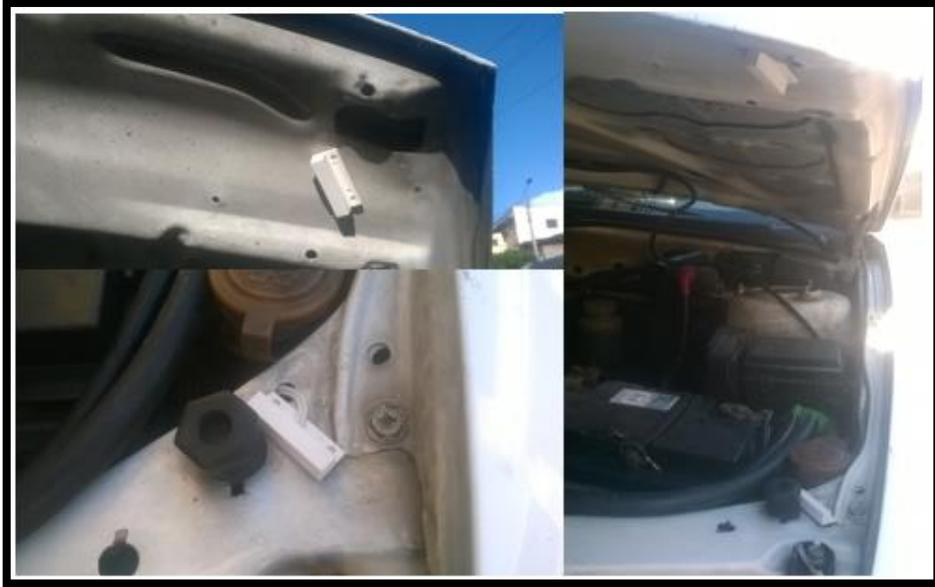
**Figura 43-2:** Instalación del sensor del capó.
