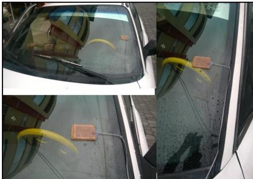
**Figura 46-2:** Instalación del sensor de gotas de lluvia.
