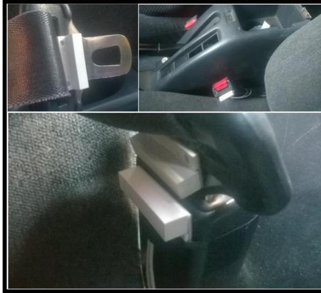
**Figura 41-2:** Instalación de los sensores del cinturón de seguridad.
