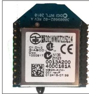
**Figura 12-2:** Direcciones del Módulo XBee
