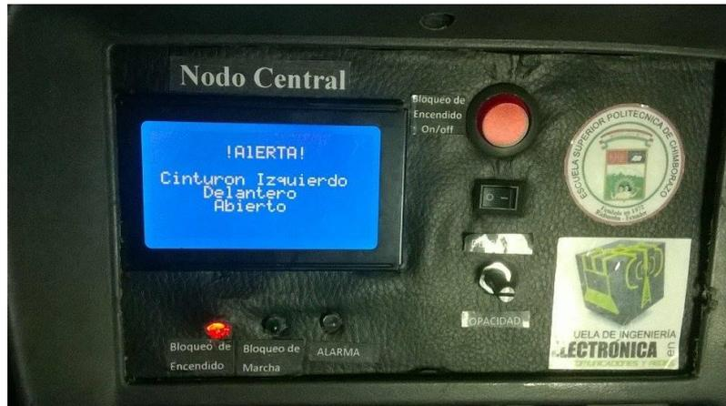
**Figura 18-3:** Alerta visual ante cinturón de seguridad izquierdo abierto.
