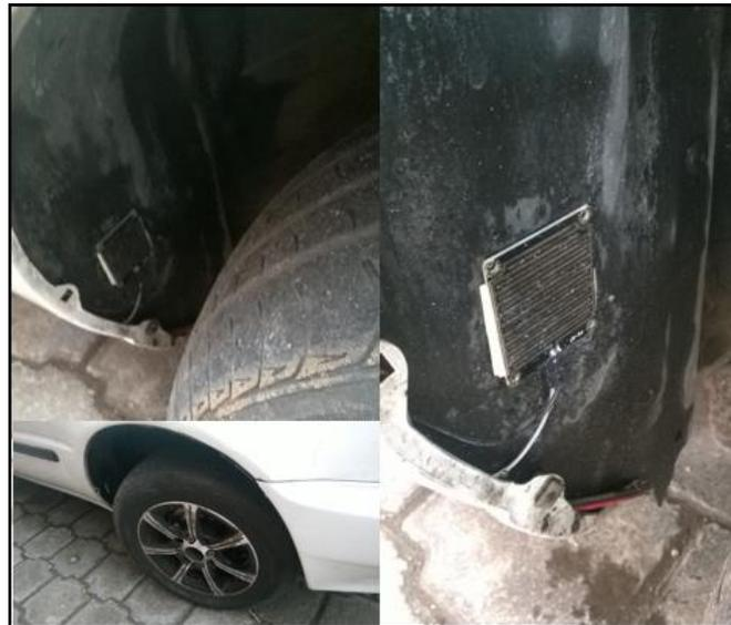
**Figura 47-2:** Instalación del sensor de humedad de calzada.
