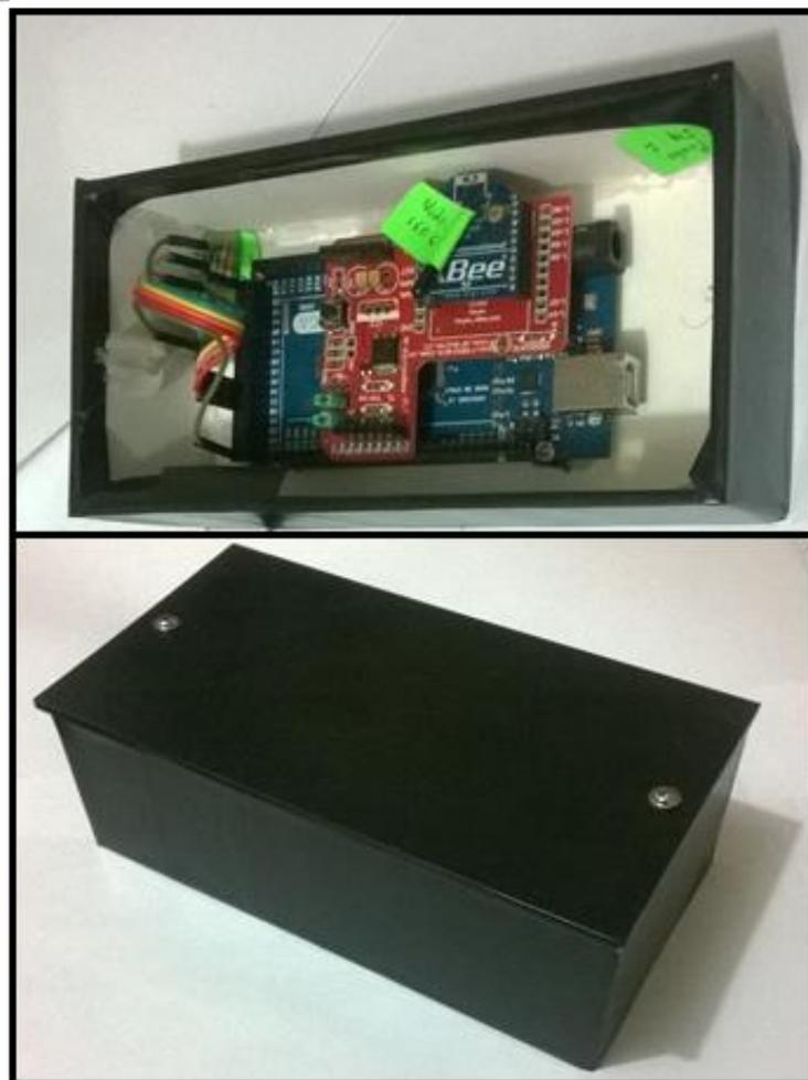
**Figura 35-2:** Caja de protección de los nodos sensores 1, 2 y 4.
