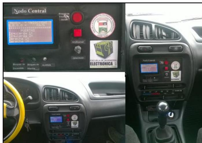
**Figura 48-2:** Instalación del nodo coordinador.
