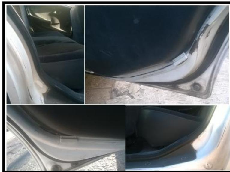
**Figura 40-2:** Instalación de los sensores de las puertas traseras.
