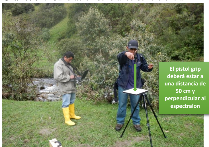
Grafico 31.- Calibración del blanco de referencia
