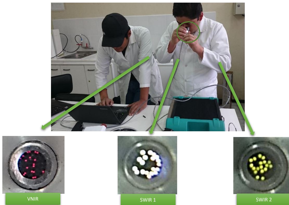
Grafico 20.- Verificación de la fibra óptica
