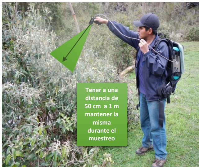
Grafico 33.- Geometría de la interacción (hombre, planta, sensor)
