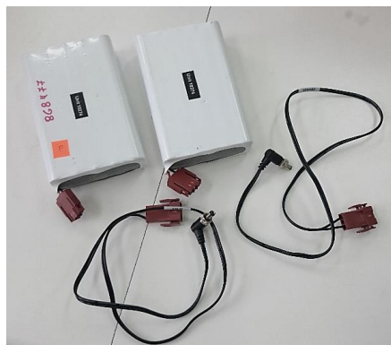
Grafico 10.- Baterías y Conectores de Baterías INPUT 12 VDC
