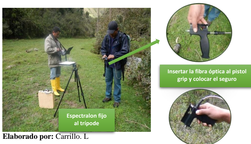
Grafico 22.- Instalación del espectralon y pistol grip
