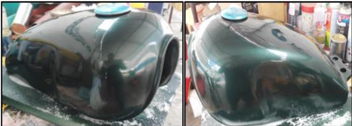
Figura 5-2 Prototipo en fibra de vidrio.
