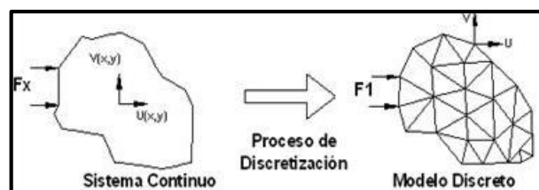
Figura 4-1 Estructura discreta y estructura continua.
