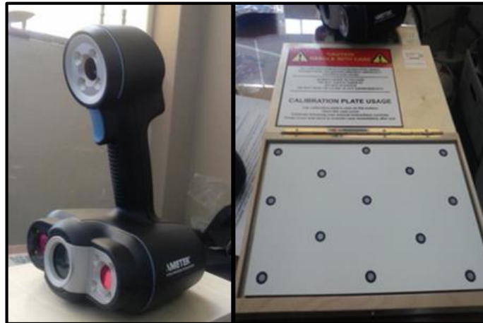
Figura 3-6 Escáner GO SCAN 3D 50 y Placa de calibración.
