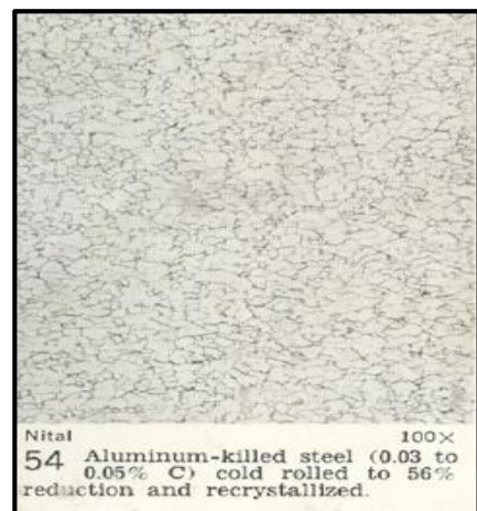
Figura 3-3 Microestructura del acero con incrustaciones de aluminio.
