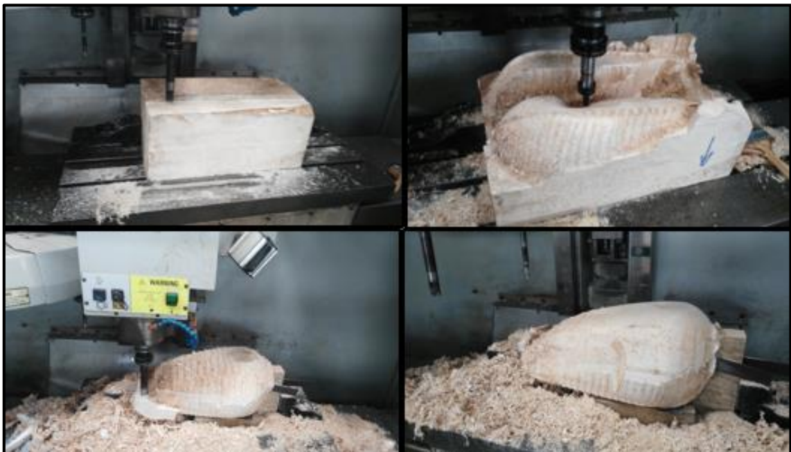
Figura 5-1 Prototipo del tanque mecanizado en madera.
