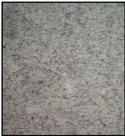
Figura 3-2 Fotografía de la microestructura del tanque de Ax 100 con 0,05 % de acero.
