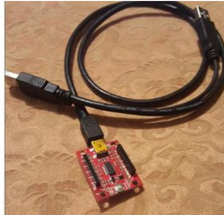
Figura 10-3 Recursos Hardware y Software para configuración de módulos Xbee S2 Autor: GARCÍA, Eduardo. 2016
