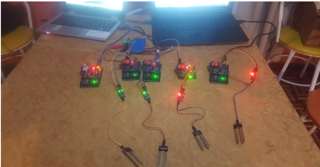
Figura 19-3 Implementación y pruebas de la WSN en el laboratorio
