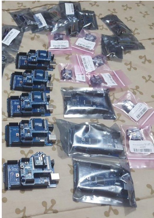
Figura 7-3 Módulos X-BEE sobre Arduino Mega Autor: GARCÍA, Eduardo. 2016
