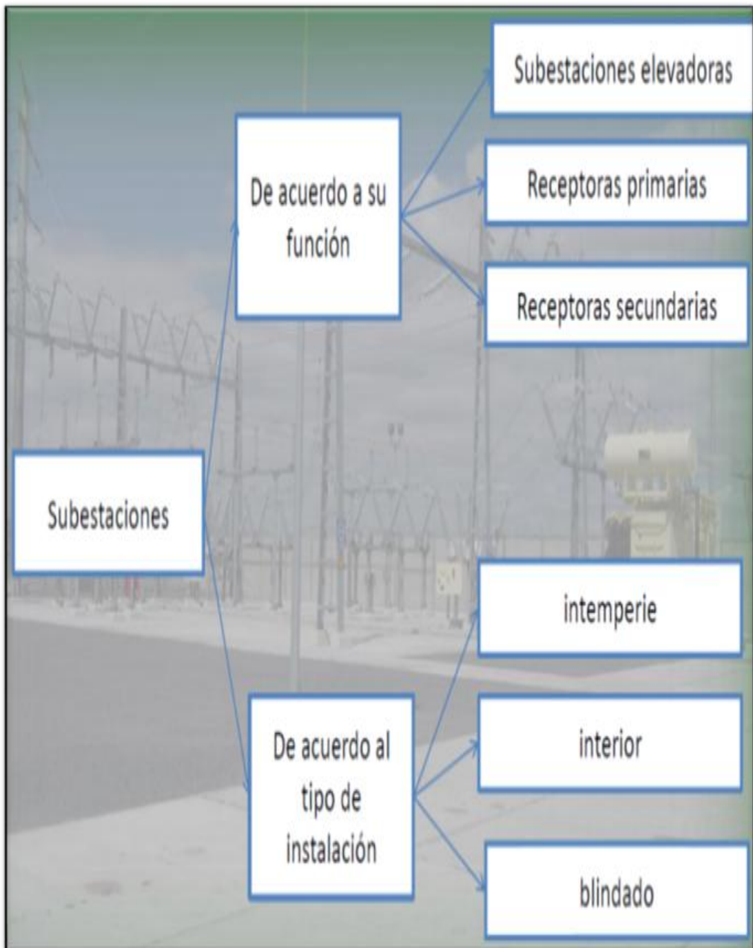
Figura 8. Clasificación de las subestaciones
