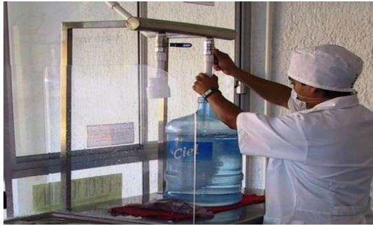
Figura 9: Proceso de llenado del agua en el bidón
