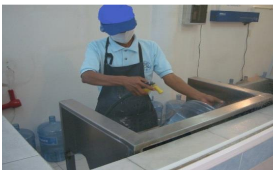
Figura 8. Proceso de lavado de bidones
