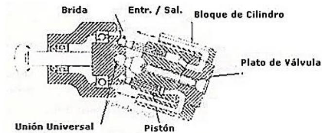
Figura 26. Motor con pistón eje inclinado
