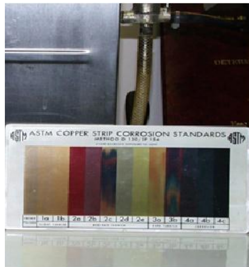
Fig. 2.2.1.1.2-1 Comparación de Colores Norma ASTM D – 130
