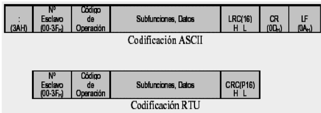
Figura III. 9.- Tramas del protocolo Modbus
