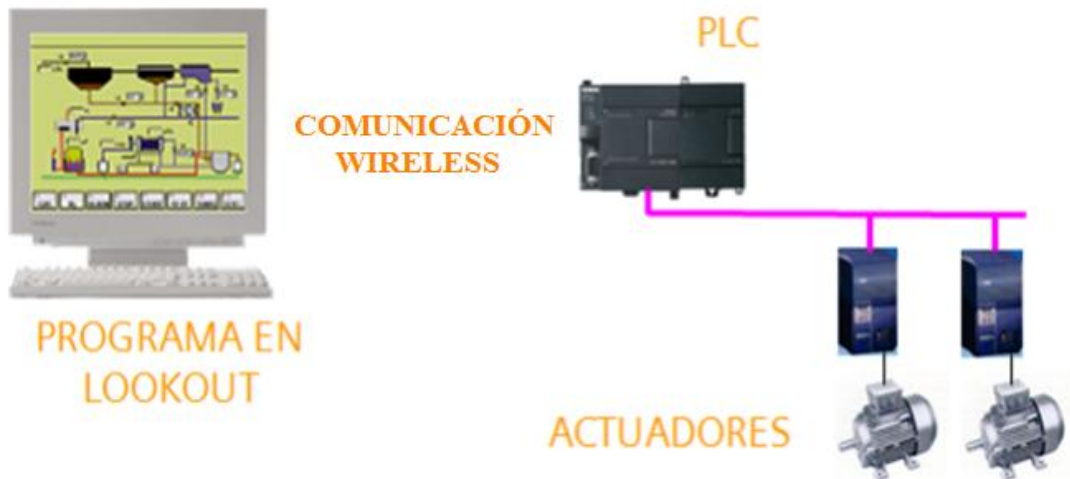
Figura VI. 61.- Componentes de un sistema Scada
