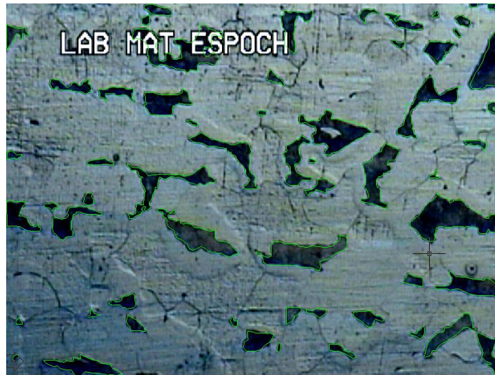
Fig.4.7 Tubería API 5L China después del recocido atacada químicamente con nital al 2 %, Escala real 5X.
