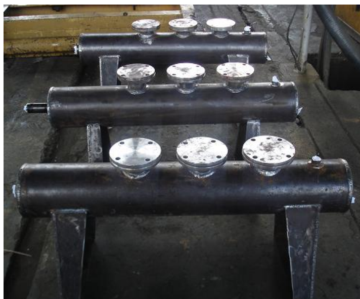
Fig.3.9 Bancos de ensayo sin anticorrosivo
