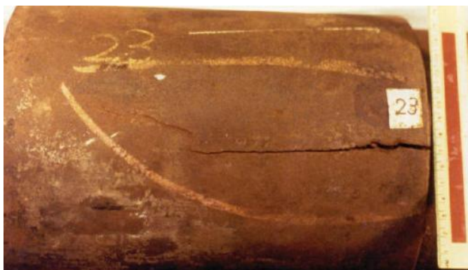
Fig.2.23 Corrosión por hidrógeno 23
