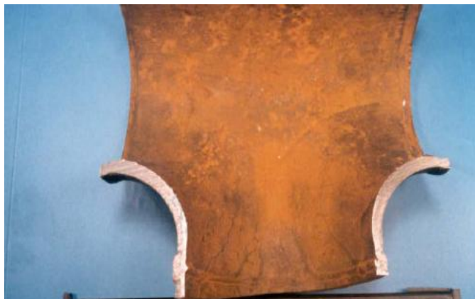
Fig.2.17 Corrosión por erosión. Tee de acero al carbón 17
