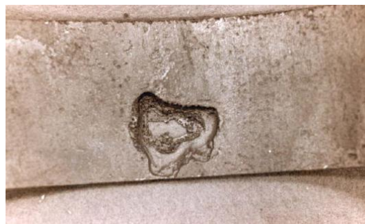
Fig2.27. Efecto terraza, ataque por bacterias 27
