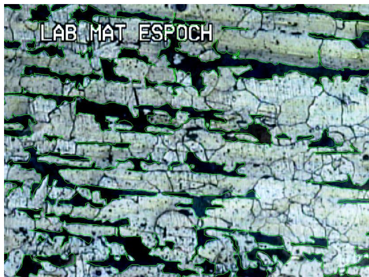
Fig.4.6 Tubería API 5L Argentina después del recocido atacada químicamente con nital al 2 %, Escala real 5X.
