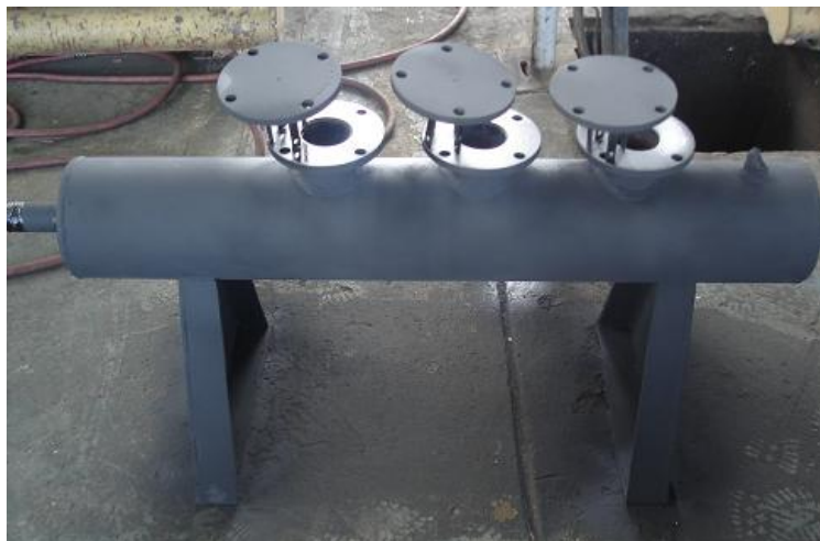
Fig.3.10 Banco de ensayo pintado con anticorrosivo negro A200
