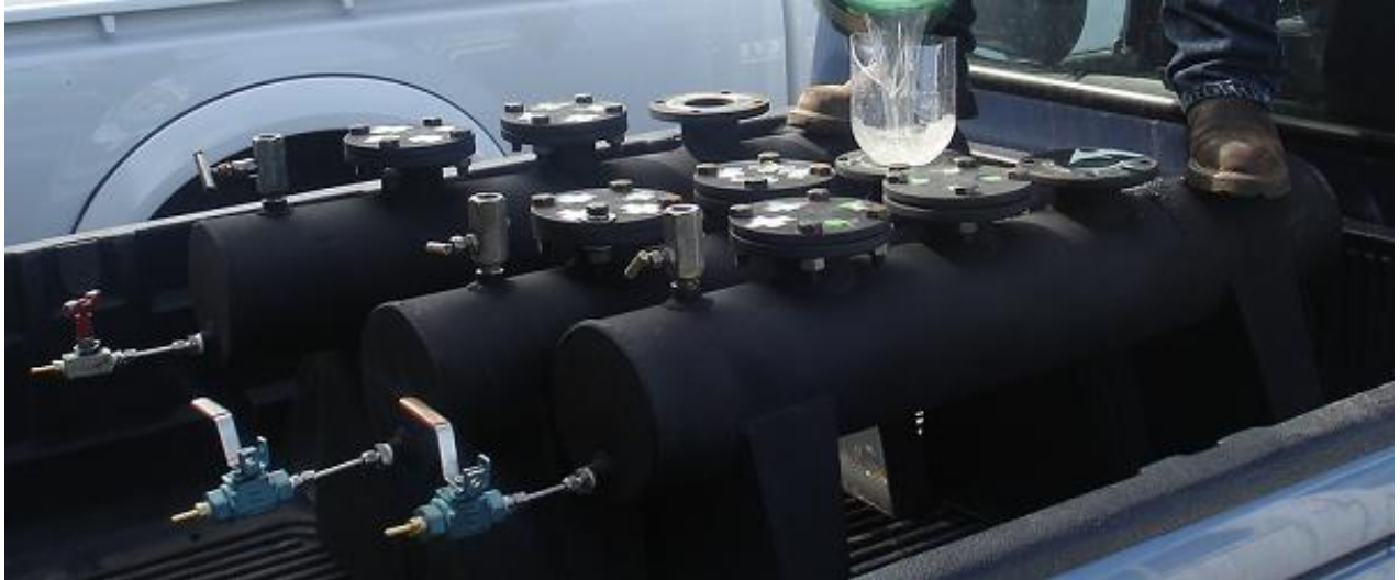
Fig.3.15. Mini reactores listos para su funcionamiento
