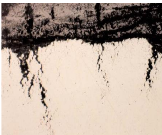
Fig.2.21 Corrosión intergranular microestructura de tubería 21
