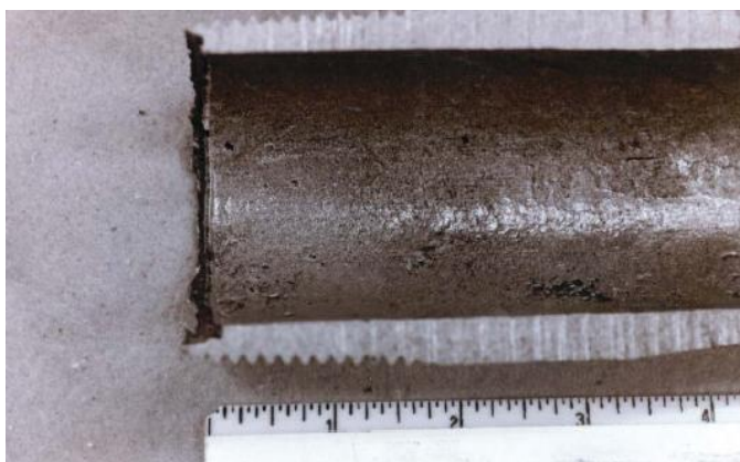
Fig.2.19 Corrosión por ranura. 19
