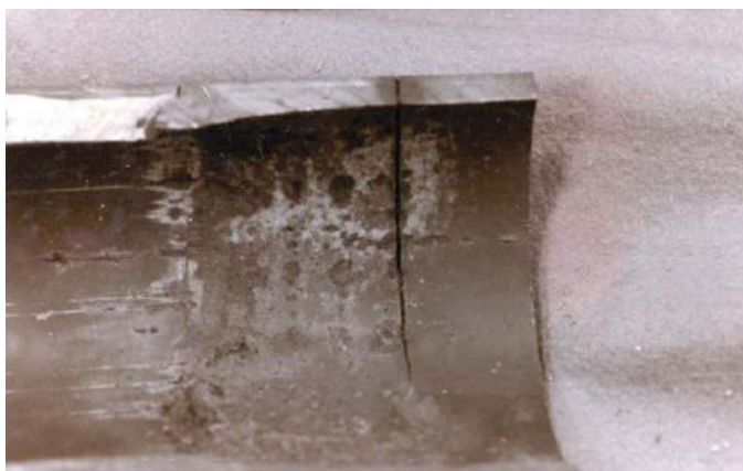
Fig2.24. Corrosión por esfuerzo en tubería de perforación. 24
