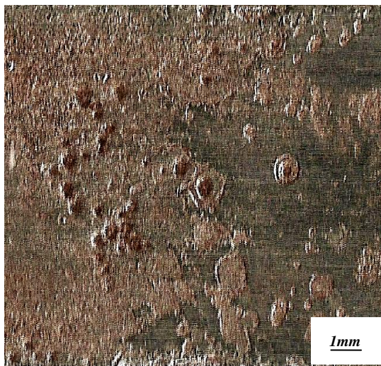
Fig.2.20 Corrosión por pitting causada por CO 2 . 20
