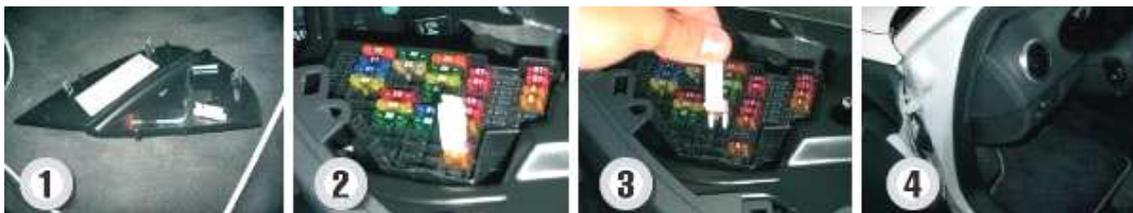
**Figura 106** Procedimiento para cambiar un fusible [20]
