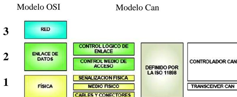
**Figura 59** Relación entre el modelo OSI y CAN [18]
