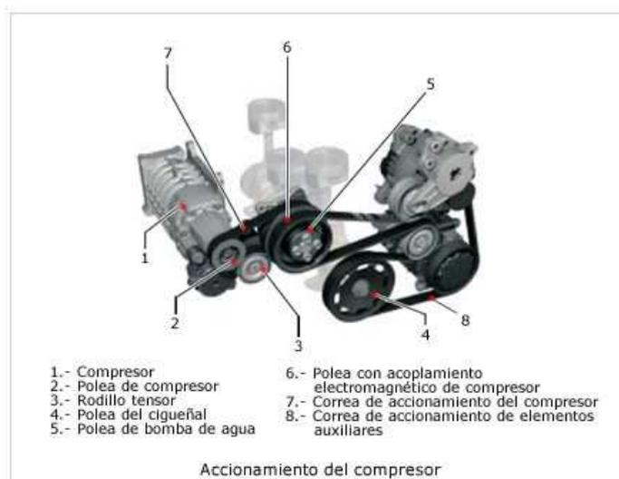
**FIGURA 3. 7 Fase mecánica del a/c**
