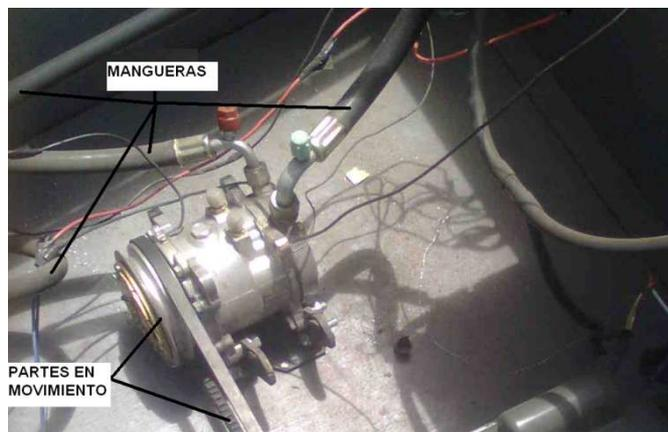
**FIGURA 3. 23 chequeo de mangueras**
