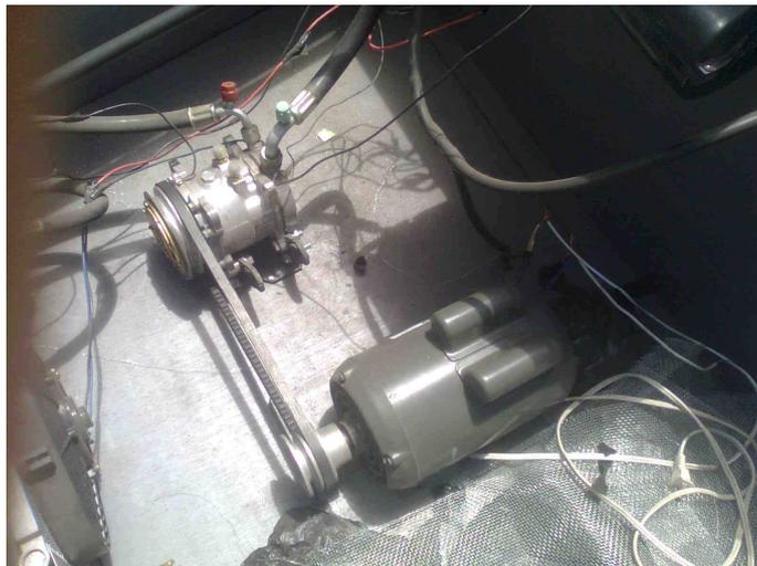
**FIGURA 3. 19 Alineamiento de motor y compresor**
