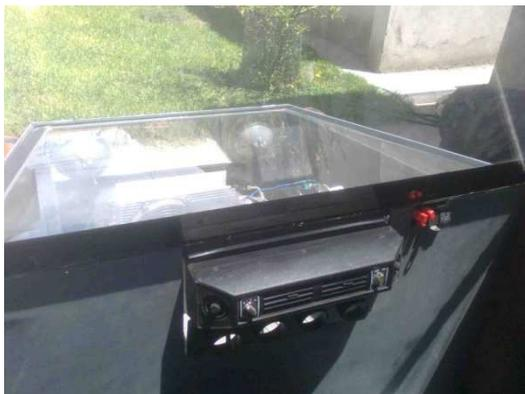
**FIGURA 4. 46 Tablero con evaporador incluido 1**
