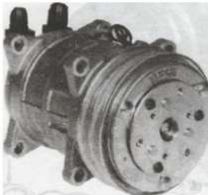
**FIGURA 2. 3 Compresor Diesel kiki**
