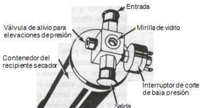
**FIGURA 2. 22 Válvula de alivio para elevaciones de presión en el recipiente**
