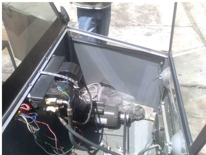
**FIGURA 4. 48 Conexiones de motor soplador 1**
