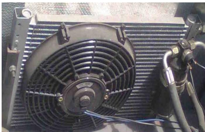
**FIGURA 3. 20 Electro ventilador y botella deshidratante**
