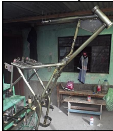
Figura 111. Chasis con capa anticorrosiva
