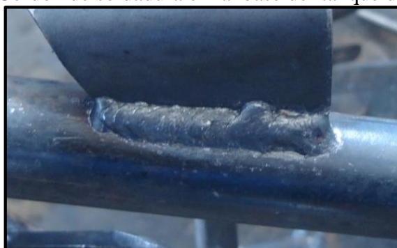
Figura 105. Cordón de soldadura en la base del tanque de combustible
