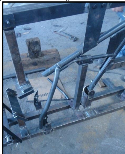
Figura 91. Ensamblaje de tubos laterales
