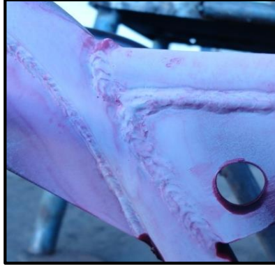
Figura 109. END- Unión tubo de enlace y tubo posterior
