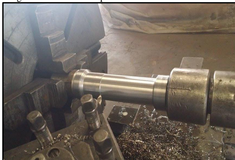
Figura 79. Mecanizado parte central del tubo de dirección
