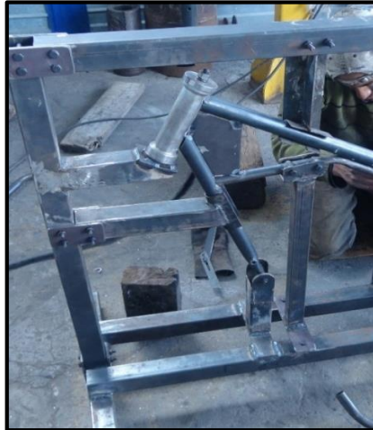
Figura 90. Ensamblaje de la parte frontal con puntos de suelda SMAW
