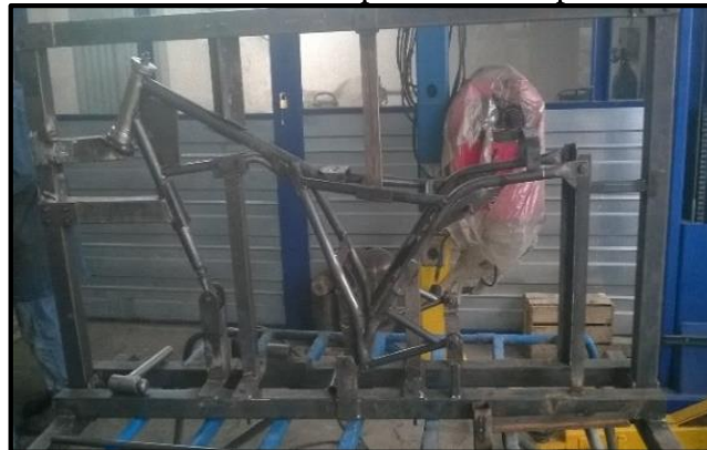
Figura 95. Chasis ensamblado por medio de puntos de suelda.
