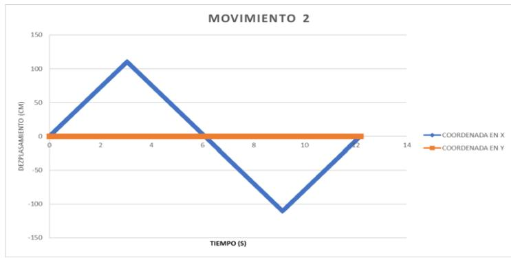
**Gráfico 2-6:** Posición del efector final en función del tiempo-Movimiento 2
