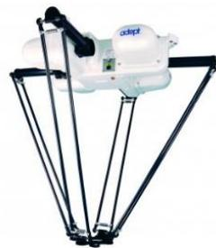
**Figura 10-2:** Robot paralelo-quattro
