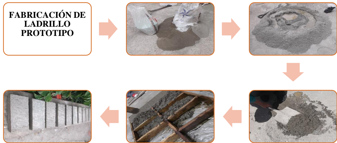
Figura 2-3: Proceso gráfico de la fabricación del ladrillo prototipo
