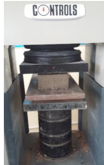
Figura 12-3: Ladrillo prototipo Cemento + Arena +PET colocado en la máquina universal Control's para ensayo de Compresión
