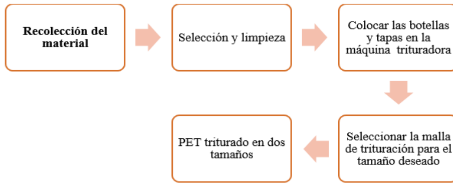
Figura 3-3: Proceso gráfico de la fabricación del ladrillo prototipo
