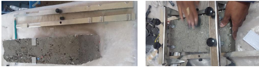
Figura 14-3: Preparación del ladrillo prototipo para ensayos de flexión
