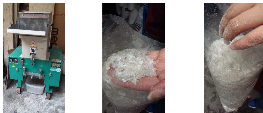
Figura 5-3: Trituración de materia prima, PET triturado dos dimensiones
