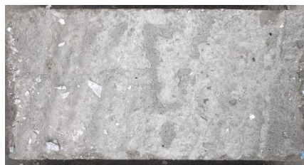
Figura 11-3: Superficie ladrillo prototipo Cemento + Arena +PET
