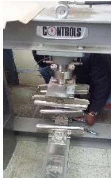
Figura 15-3: Distancia entre apoyos para realizar el ensayo de Flexión
