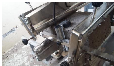
Figura 16-3: Posición inicial del ensayo de flexión en el ladrillo prototipo
