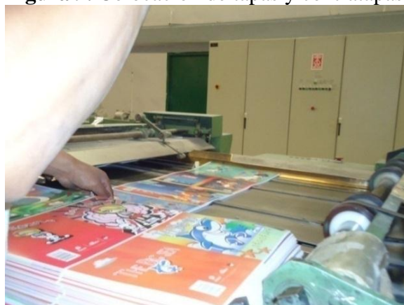
Figura 9. Colocación de tapas y contratapas.
