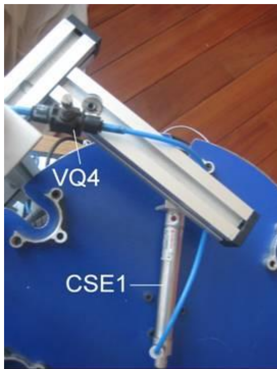
Figura 3.21. Elementos Neumáticos en Módulo de Expulsión.
