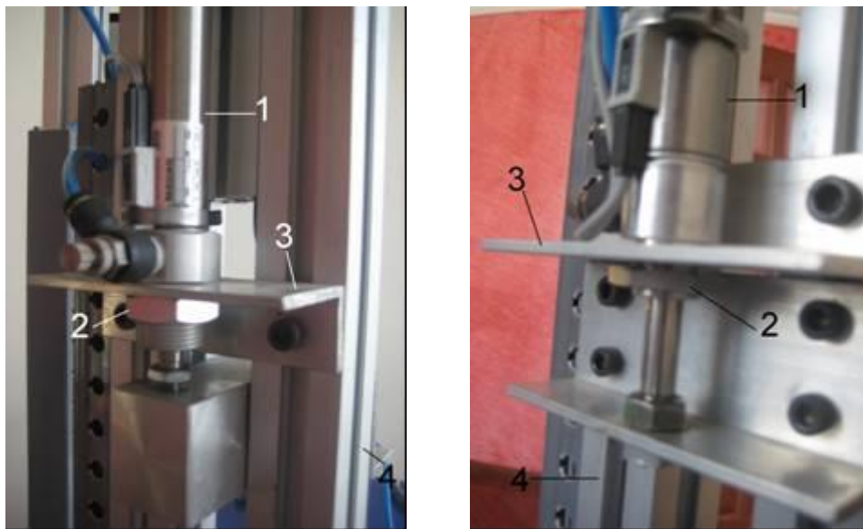
Figura 3.17. Montaje de Cilindros Neumáticos.
