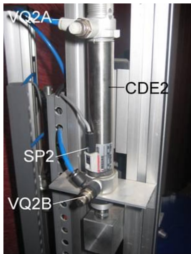
Figura 3.19. Elementos Neumáticos del Módulo de Taladrado.
