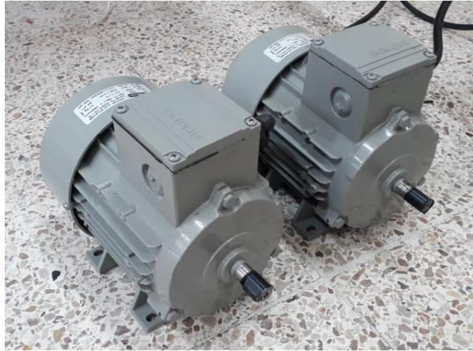
Figura 3-6: Motores trifásicos SIEMENS de 0.5 y 0.75 HP Fuente: Autores 2019
