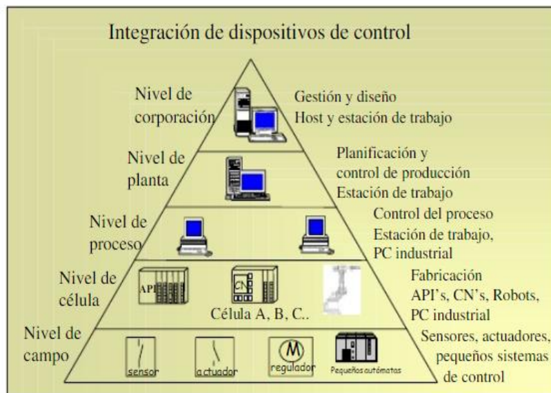
Figura 2-1 Estructura Jerárquica de las Comunicaciones Industriales Fuente: Bus de campo en comunicación industrial. 2011
