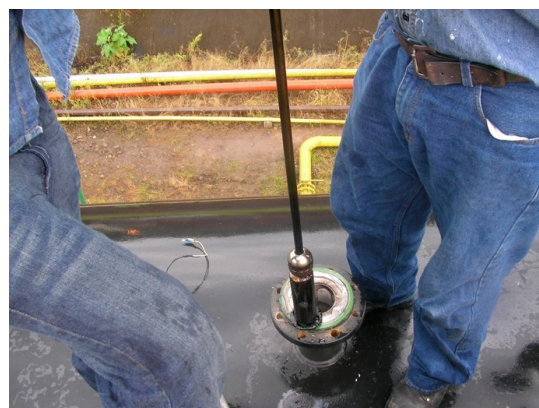
Figura2. Medidor de interfase del tipo boya
