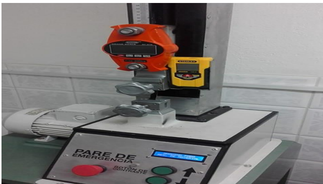
Fotografía 1. Partes de un equipo para realizar la medición de la resistencia a la tensión el cuero.
