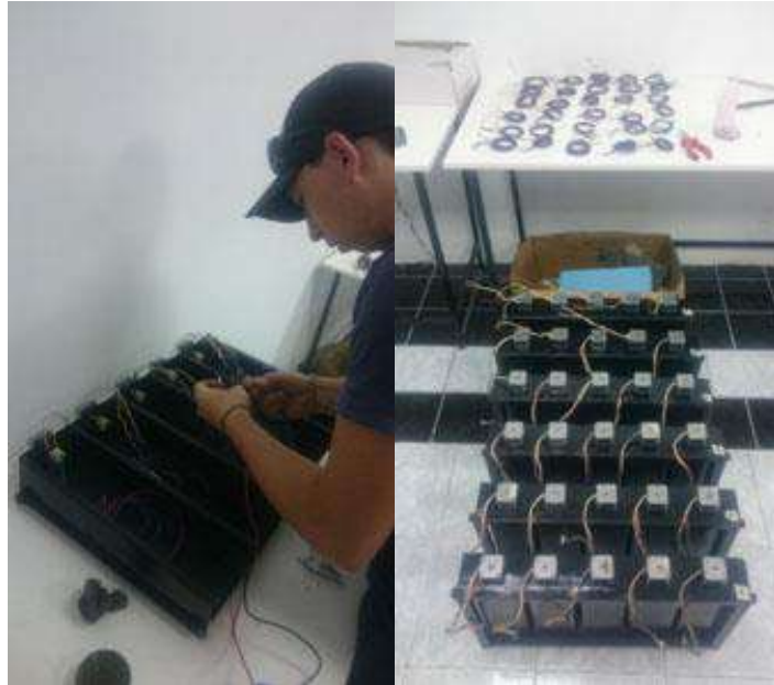
Figura 40-2: Montaje de motores en las bandejas
