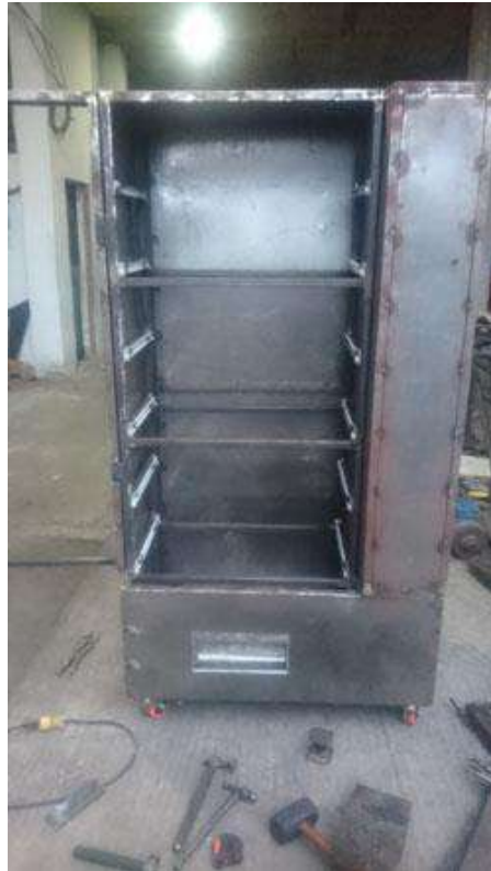
Figura 38-2: Colocación de llantas y tapas
