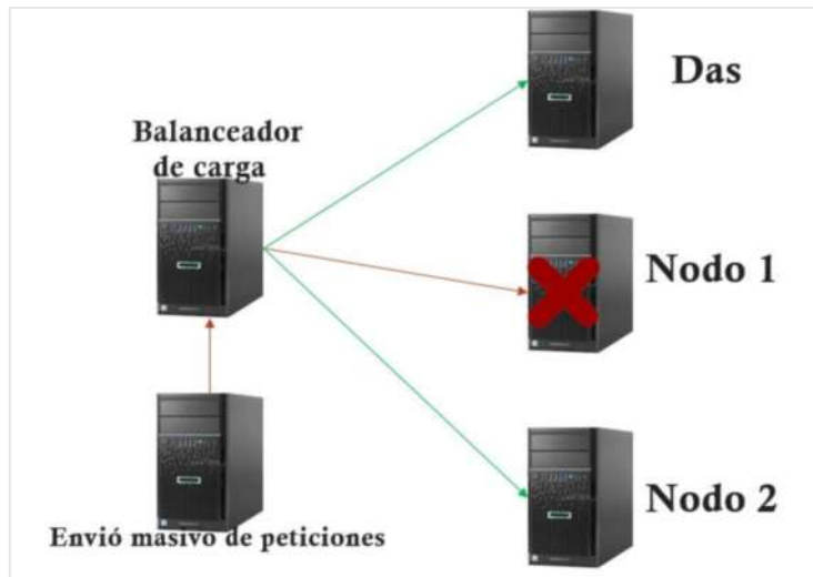
Figura 19-2: Esquema de balanceador de carga y servidores de aplicaciones Realizado por: Zaruma Jorge. 2019
