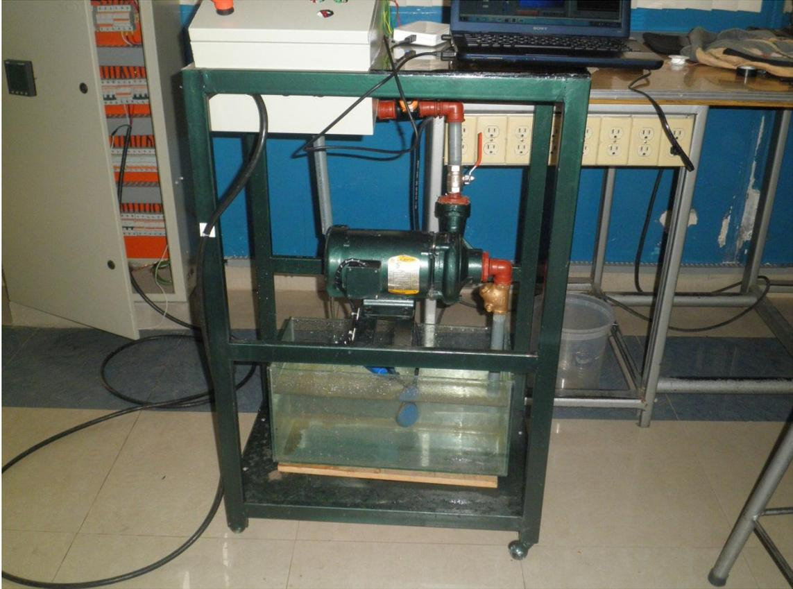
Figura III.25 Soporte, tubería y panel de instrumentos del módulo de control de flujo.
