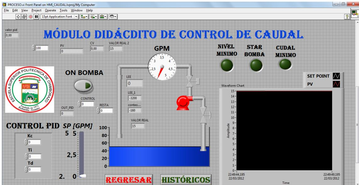
Figura VI.51 Pantalla HMI indicador caudal mínimo apagado
