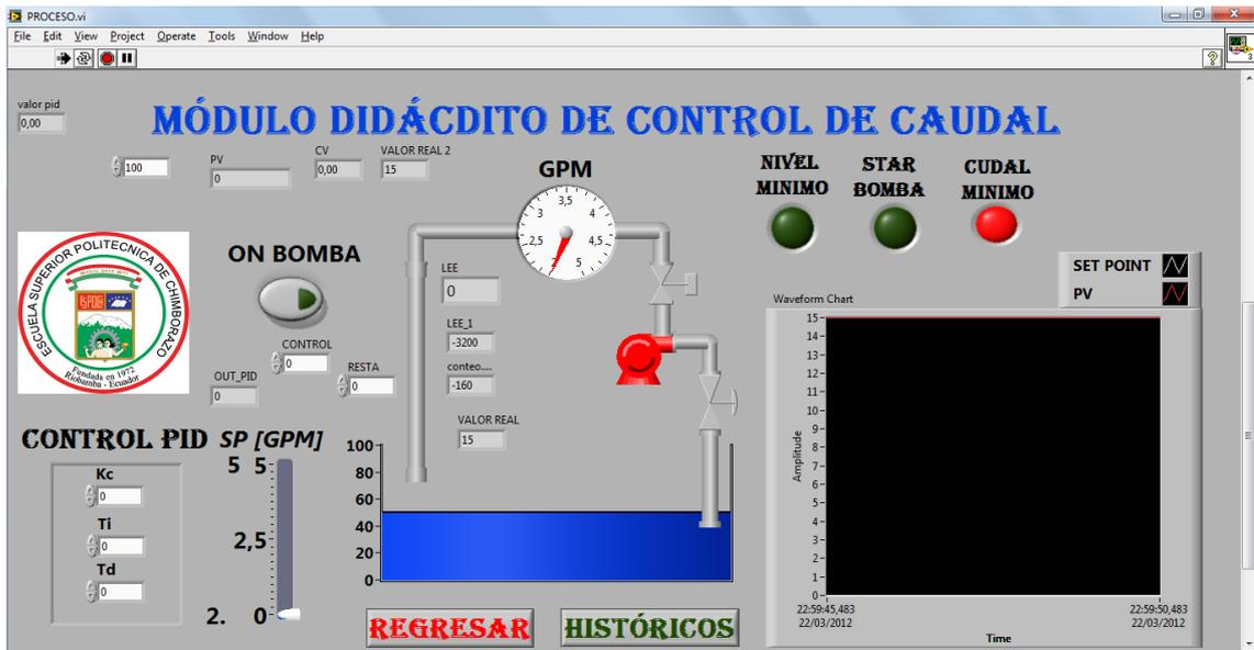
Figura VI.49 Pantalla HMI indicador caudal mínimo encendido
