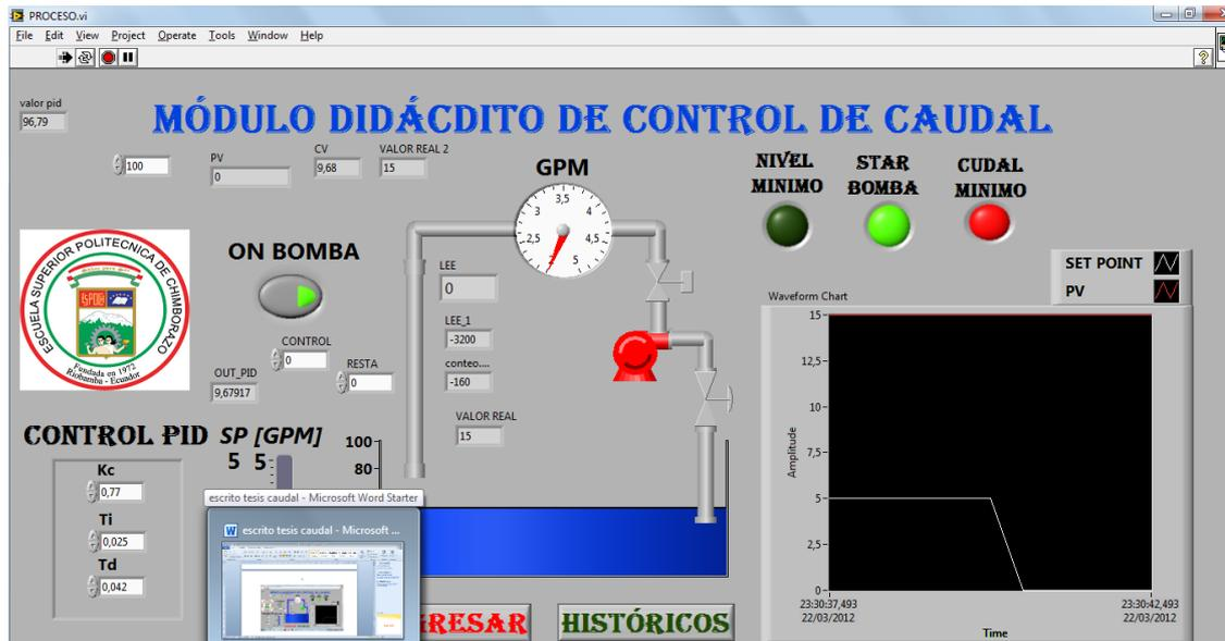
Figura VI.55 caudal de 5 a 2gpm
