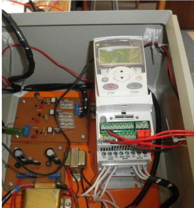
Figura VI.56 Pruebas del variador desde al panel del variador a 20 HZ
