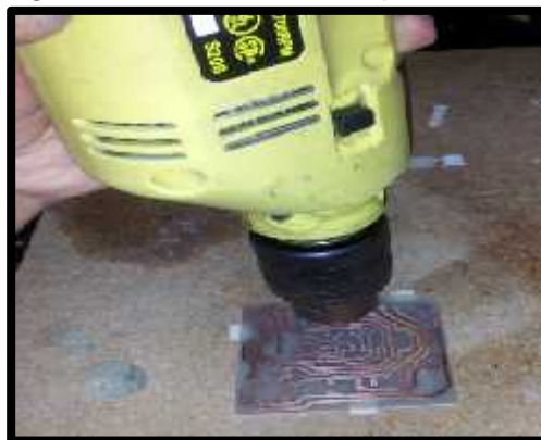
Figura 46. Perforado de la placa
