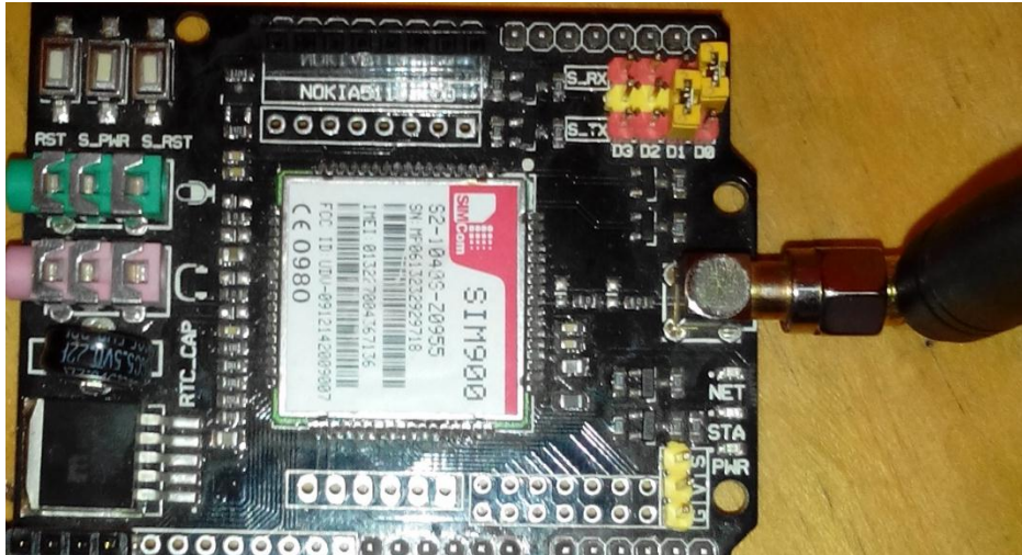
Figura 62: Conexión de jumpers del Shield
