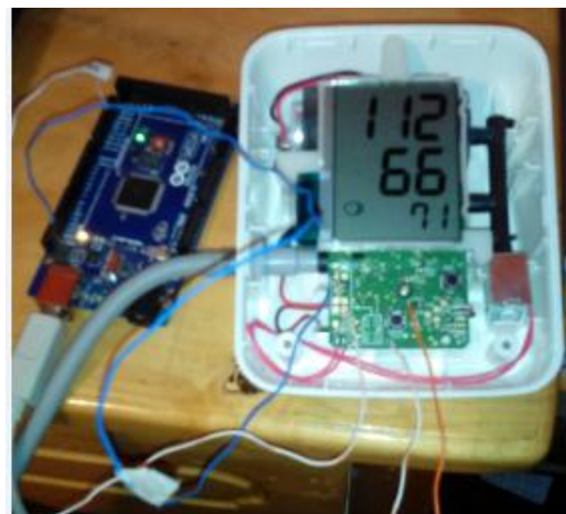
Figura 53: Resultado 1 de la transformación de los valores obtenidos con el Omron en programación Arduino
