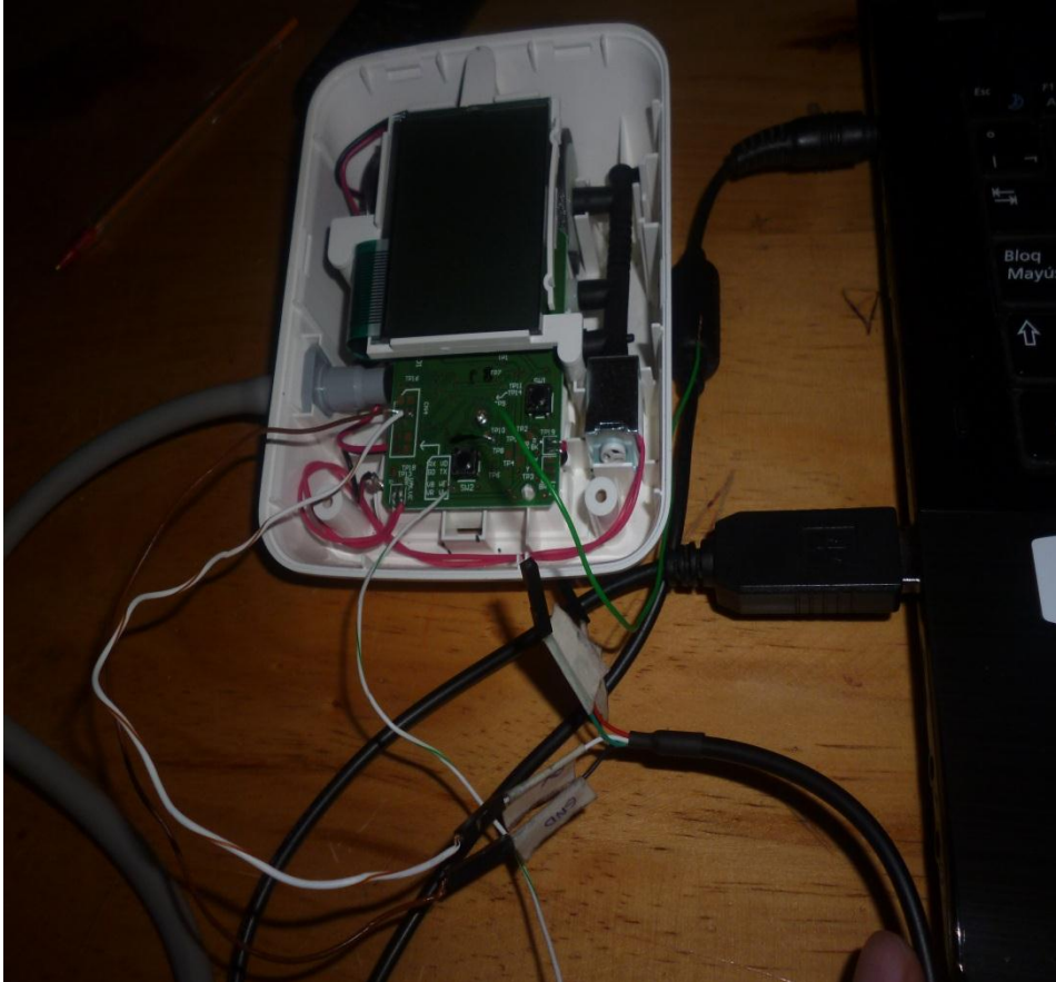
Figura 59: Conexión del omron de cable serial a usb
