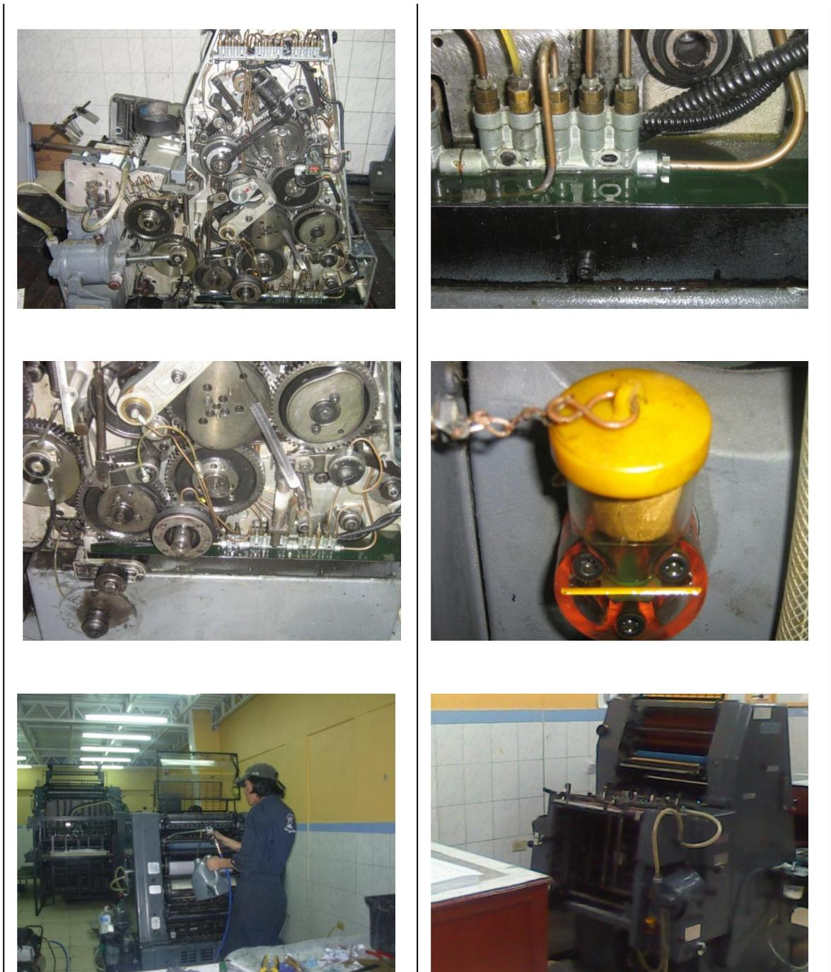
Figura. 5.9: Lubricación de la Impresora GTO - 46.
