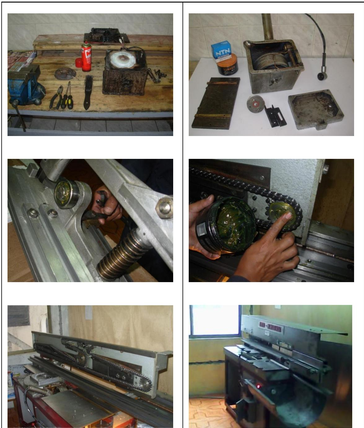
Figura. 5.16: Lubricación y Condiciones Básicas de la Encoladora.
