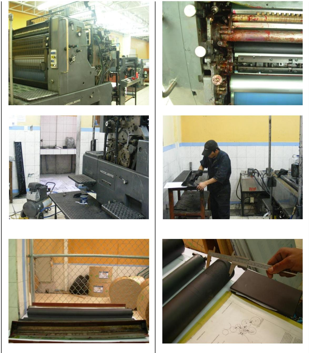
Figura. 5.10: Limpieza y Ajustes de la Impresora SORS-Z.
