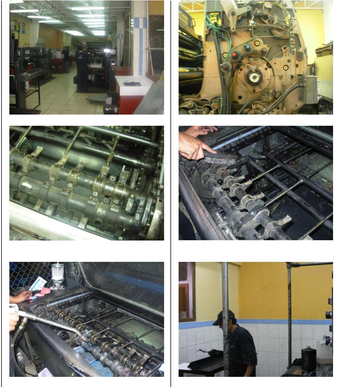
**Figura. 5.13:** Limpieza Ajustes y Lubricación de la Impresora SOR-K .
