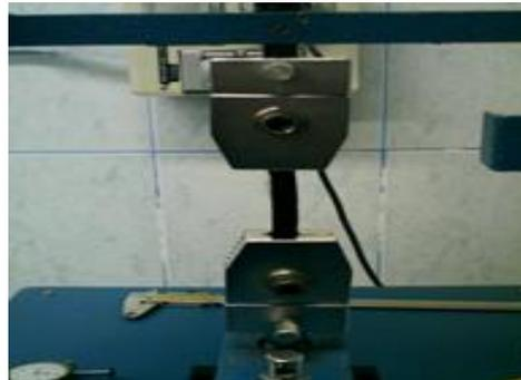
Fotografía 4. Probeta sujeta a las mordazas.
