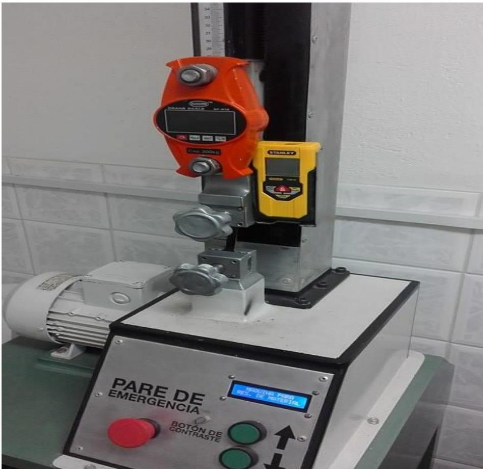
Fotografía 1. Esquema del equipo de medición de la resistencia a la tensión del cuero.
