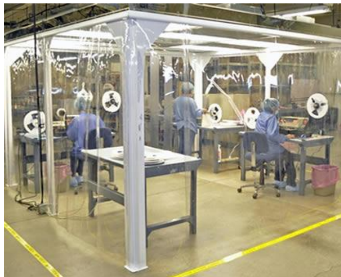
Figura 2-2: Cuarto limpio modular de paredes blandas.
