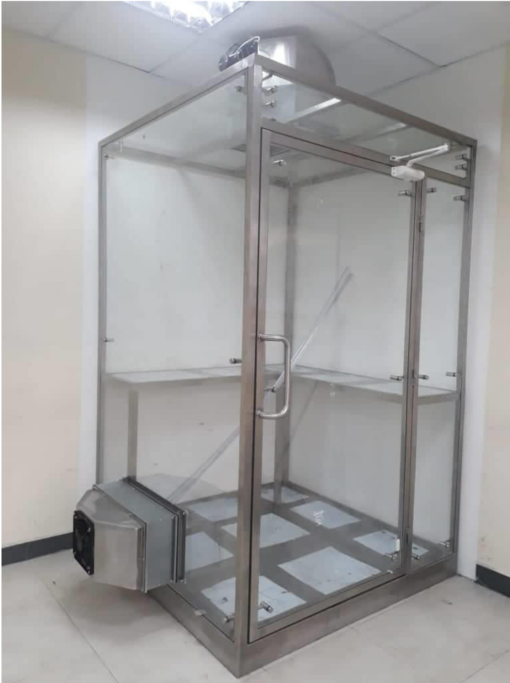
Figura 51-3: Montaje de filtros y ventiladores.
