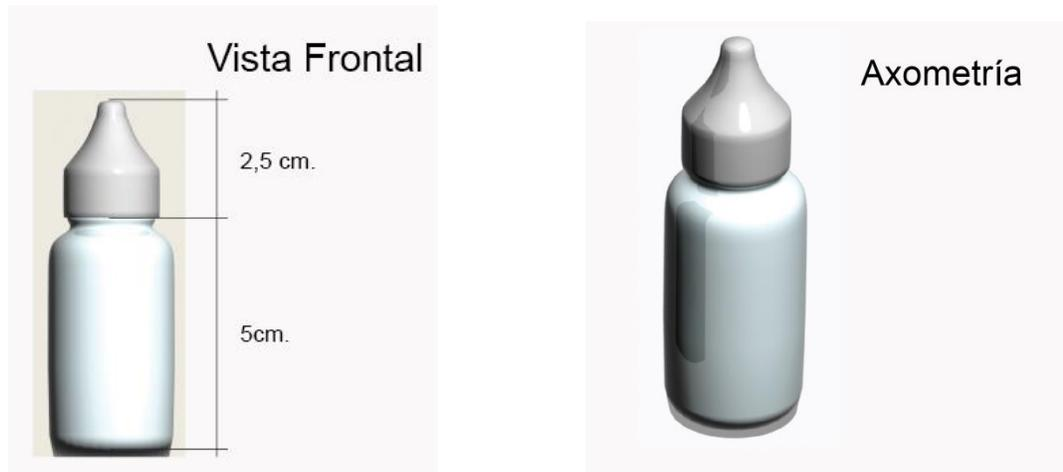
**FIGURA IV. 056** Diseño Envase Primario Gotas
