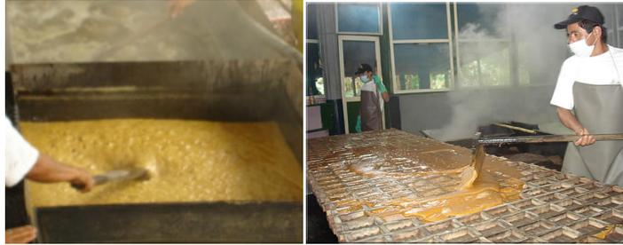
**Figura 2.7:** Batido y moldeo de la panela.
