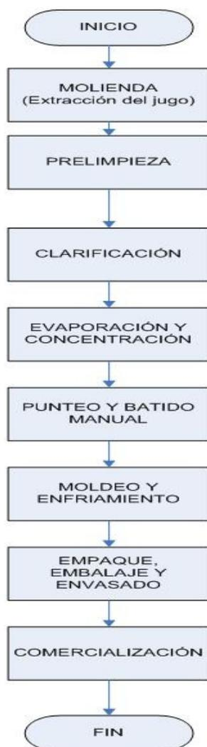
**Figura 2.1:** Diagrama de flujo del proceso de obtención de la panela.
