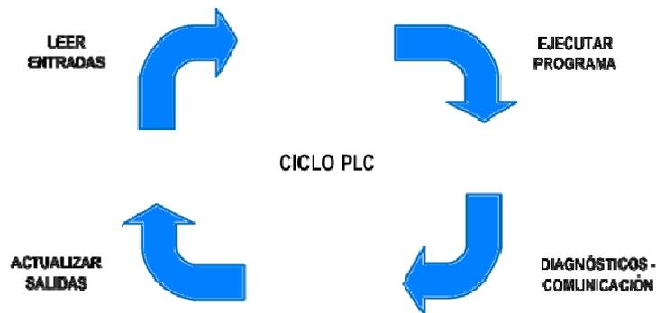
*Figura IV 3 Ciclo de Funcionamiento del CPU de un PLC*
