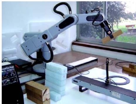
*FiguraIII-22Brazo Robótico controlado para Mover figuras*
