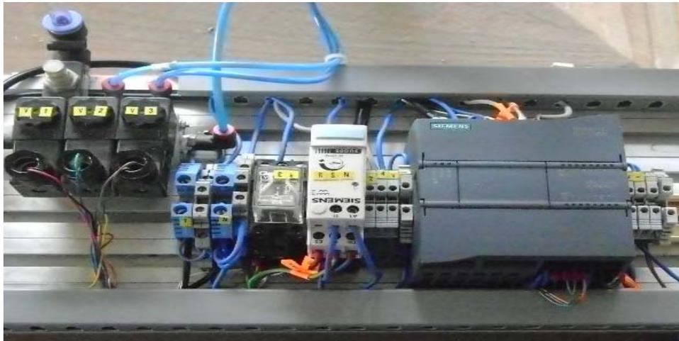
*Figura VI-92 Modulo de control del sistema de mezclado de líquidos*
