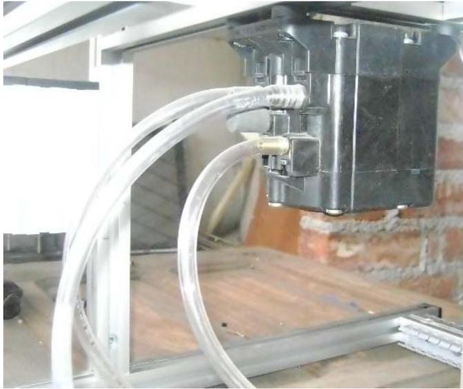
*Figura. VI-94. Conexión de la Bomba*
