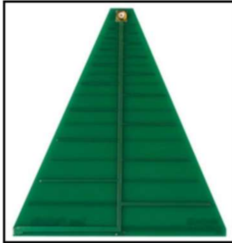
Figura 7-2: Antena logarítmica de 400MHz a 1 GHz
