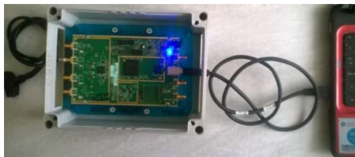
Figura 11-3: Conexión USRP y el ordenador por medio cable USB.
