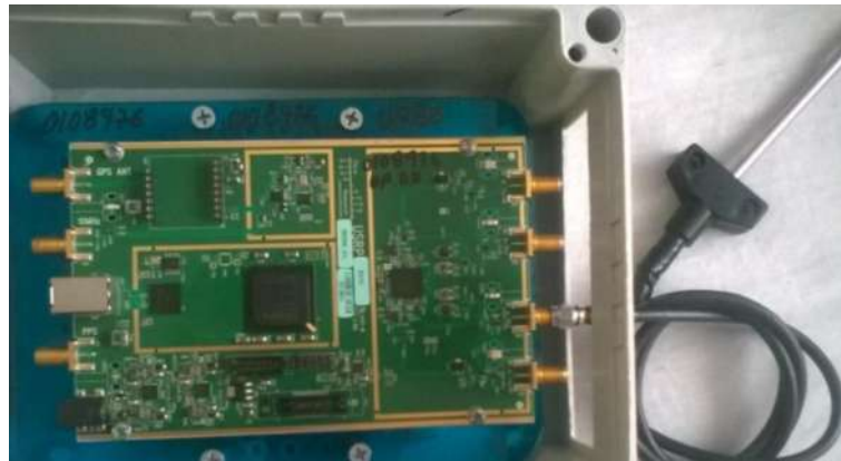
Figura 8-3: Conexión antena y USRP.
