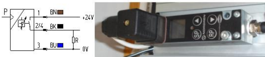
Fig. 56 Símbolo y apariencia del presostato.
