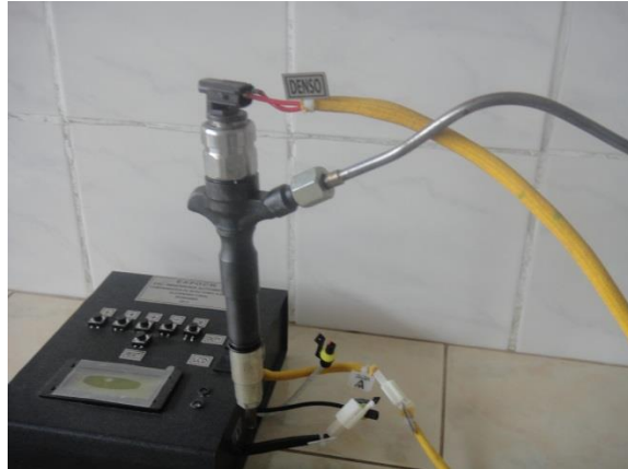
Figura 82. Conexión inyector módulo y manómetro
