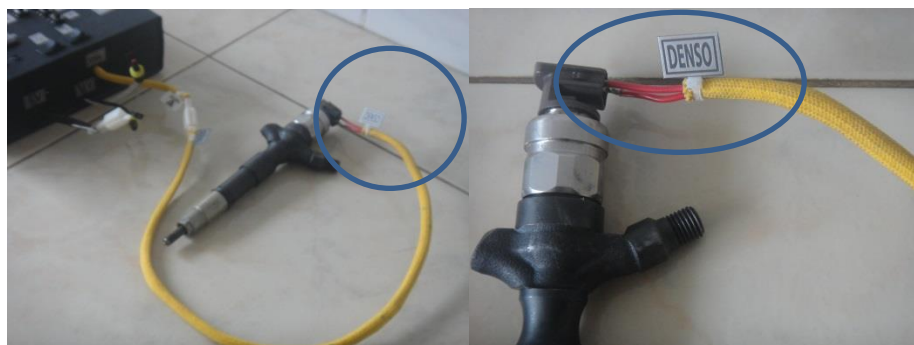
Figura 95. Conexión cable señal del módulo con el inyector
