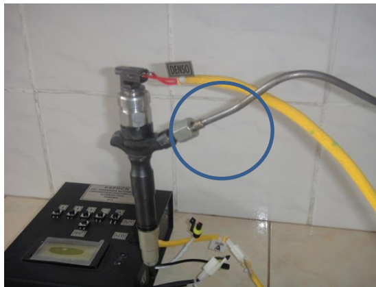
Figura 94. Cañería del manómetro con el inyector
