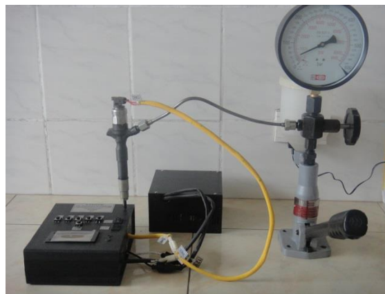
Fig. 83 ensamblaje total del comprobador CRDI
