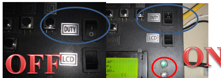
Figura 103. Activación interruptor del DUTY
