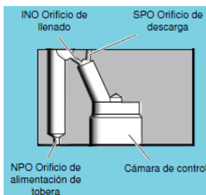
Figura 33. Placa separador del inyector DELPHI
