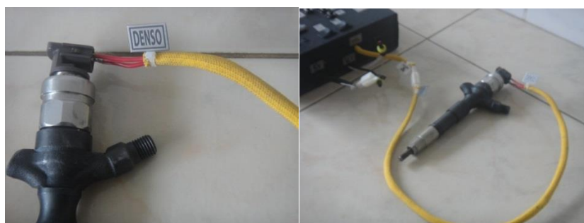
Figura 81. Conexión módulo con inyector diesel
