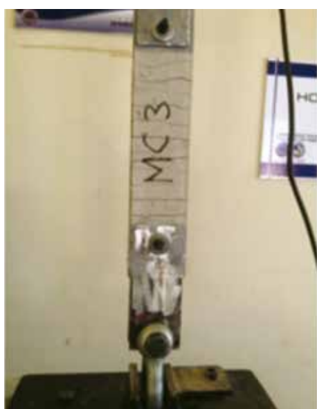
Figura 5. Ensayo de tracción de material compuesto FRCM reforzado con tejido de saco y tejido diseñado.
