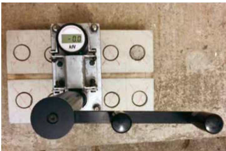
Figura 8. Configuración de la prueba de pull-off .
