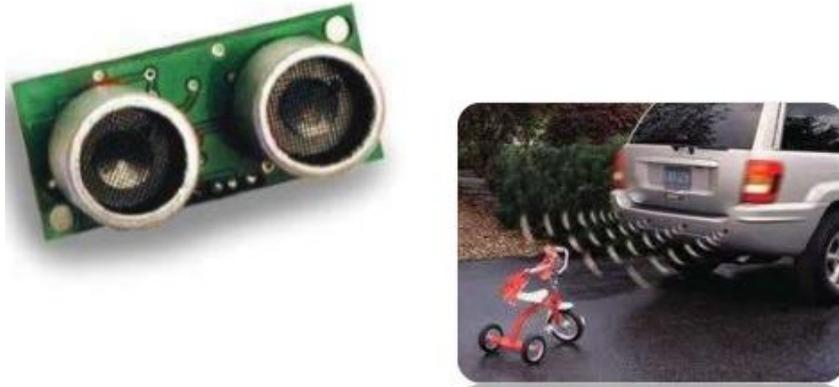
**Figura III- 66 Ejemplo de sensor ultrasónico**
